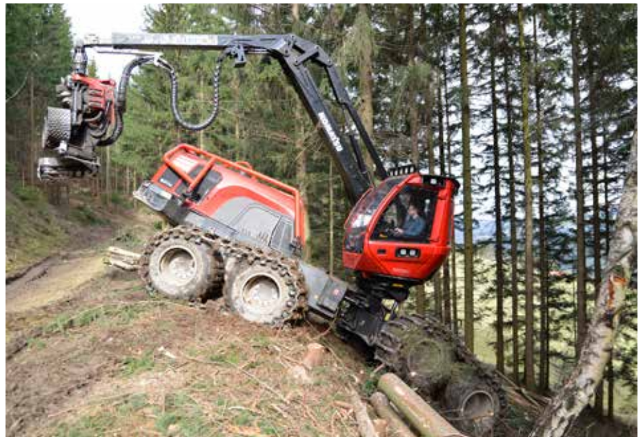
Kahdeksanpyöräisen hakkuukoneen telin kaksoiskeinuakseli ja päälle asennetut telat mahdollistavat ajamisen jyrkillä ja pehmeäpintailla penkereillä maaperää säästäen.
