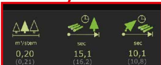
Les chauffeurs peuvent maintenant suivre et surveiller leur efficacité, directement sur l'écran de conduite. L'écran comporte des icônes pour le volume, le nombre de tiges, la tige moyenne, le délai entre le relevage de la tête d'abattage et la coupe suivante, le temps d'abattage, la consommation de carburant et le taux d'utilisation technique.
