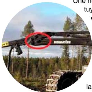
Une nouvelle solution pour protéger les tuyaux a été développée pour la grue de l'abatteuse Komatsu 951. Une plaque de protection avec une transition douce a été montée sur le bord et les tuyaux ont été remplacés par des tuyaux plus longs avec une classe de pression supérieure et une gaine de protection. Cette solution prolonge la durée de vie des tuyaux et augmente la fiabilité de la machine.
