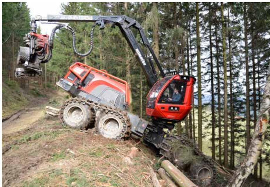
Grâce au système de bogie unique à double oscillation de l'abatteuse à huit roues et aux chenilles, il est possible de passer les talus abrupts à la surface meuble d'une manière qui ménage le sol.
